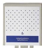
SINTECOM-4 transmetteur vocal autonome • Entrées: 4 • Messages: 4 • N° de téléphone: 6 • Consommation: 115mA • Dimension boîtier (LxHxD): 140 x 110 x 50 mm • la programmation se fait en connectant un téléphone DTMF
