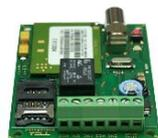
Module GSM avec 2 entrées et 1 sortie pilotable, pour relier un appareil sans transmetteur intégré au canal GSM. Les entrées peuvent envoyer un SMS, des messages vocaux ou un rapport Contact ID.
