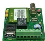
Module GSM avec 2 entrées et 1 sortie pilotable, pour relier un appareil sans transmetteur intégré au canal GSM. Les entrées peuvent envoyer un SMS, des messages vocaux ou un rapport Contact ID.
